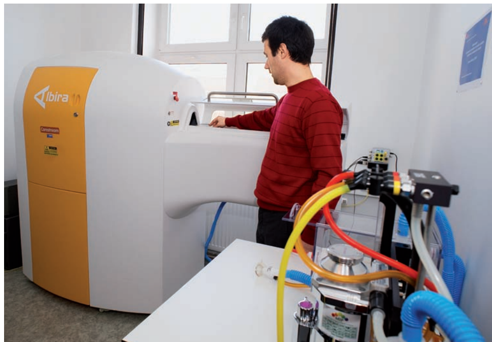
Přístroj \mu CT/PET doplněný o anesteziologickou jednotku a systém pro sledování vitálních funkcí (respirační pohyby, EKG a tělesná teplota). | Foto: Leoš Chodura
