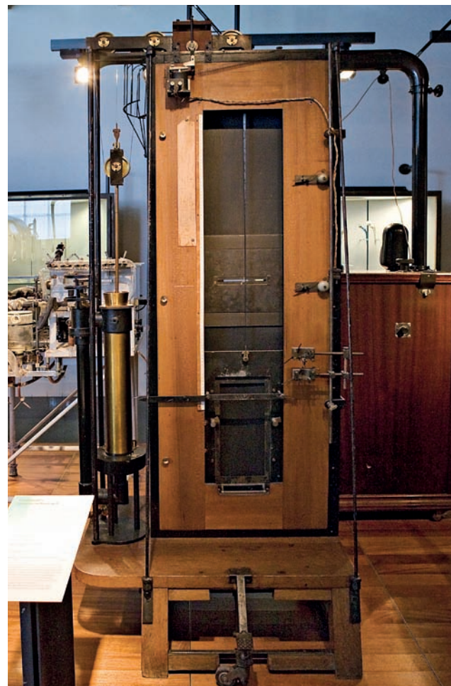
Einthovenův strunový galvanometr svým tvarem a velikostí připomíná telefonní budku.
