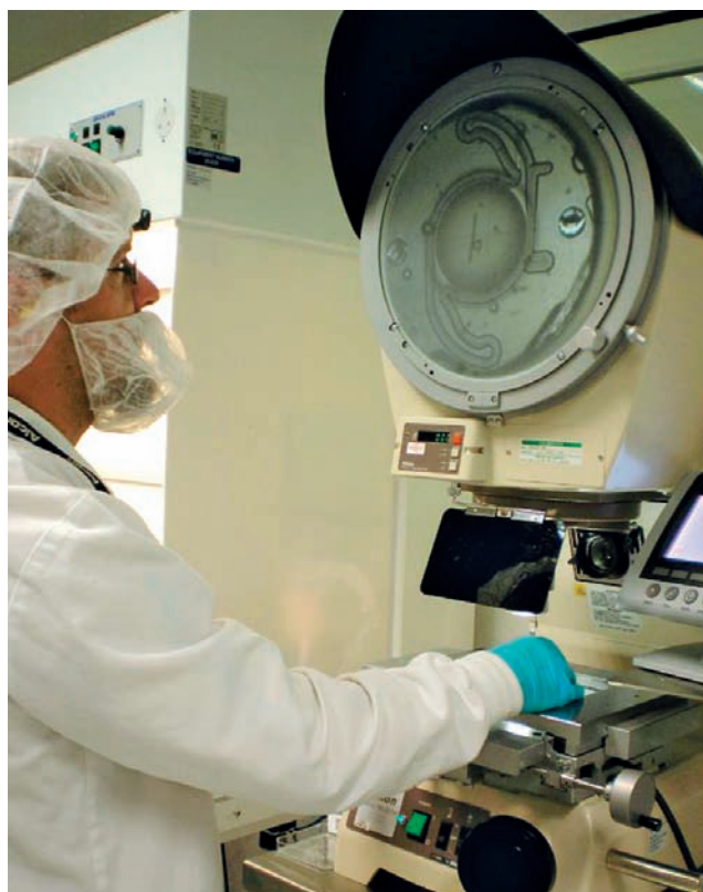
Optická kontrola správného tvaru a velikosti čočky pod zvětšovacími přístroji. | Foto: archiv společnosti Alcon
