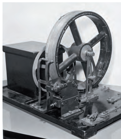
První polarograf postavený na univerzitě, jenž se stal vzorem pro komerční nástroje. | Foto: electrochem.cwru.edu
